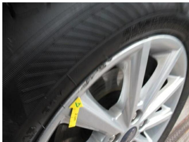
2. Außen, 1 Leichtmetallfelge, beschädigt , instandsetzen
