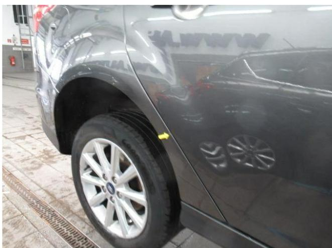
3. Außen, Seitenteil hinten rechts, Kratzer, smart repair
