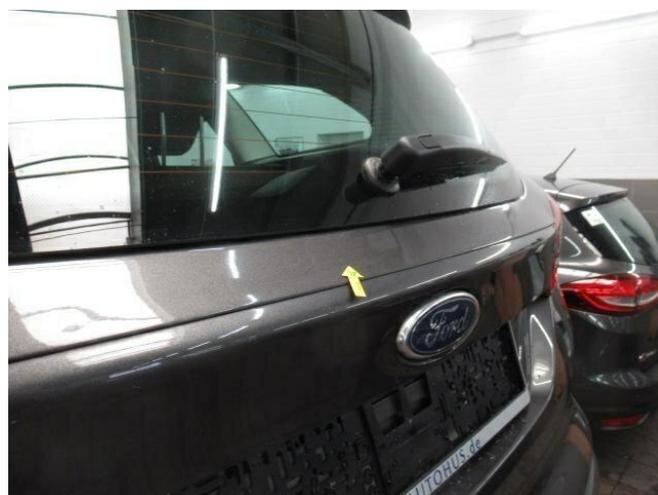
4. Außen, Heckklappe, Delle, smart repair
